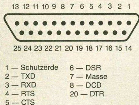
Bild 1. Die wichtigen Anschlüsse der RS232-Schnittstelle für die Datenübertragung zwischen zwei Computern
