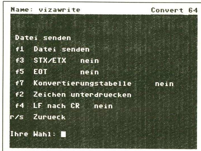
Bild 3. Die Dateien können mit verschiedenen Parametern und Steuerzeichen (etwa LF nach CR) übermittelt werden
