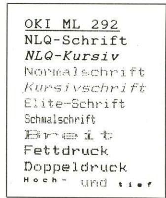
Bild 8. Die Schriftqualität des ML 292 mit 18 Nadeln ausgedruckt — fast perfekt
